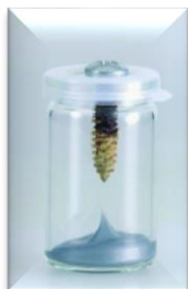
Dichtstoff mit Lösungsmittel Es entsteht Korrosion!
